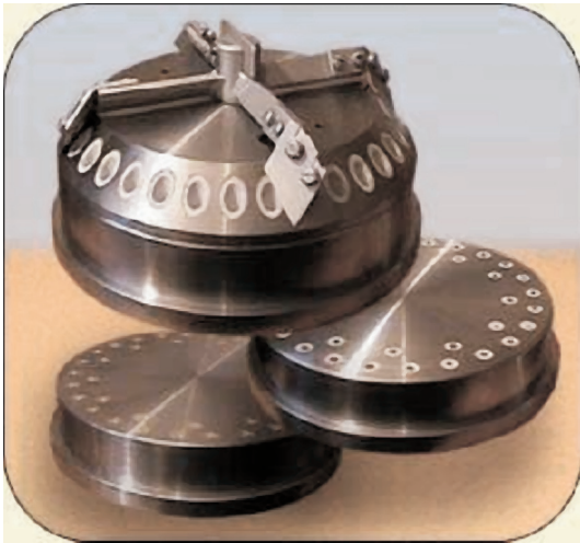
Рис.2. Филера (волока) для изготовления спагетти
